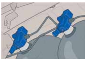
Elektromagnetyczne zawory odcinające na zbiornikach gazu
